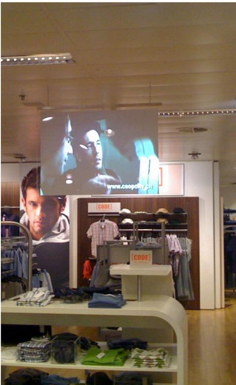
Rückprojektion auf Rückprojektionsplatte mit Folie und Digital Projektor
