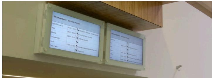
aufgesetzte 32" Displays mit Schutzglas
